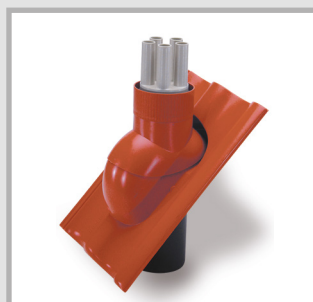
MSD110 mit fünf Stutzen und fünf Thermo-Schrumpfmuffen Geeignet für fünf Kabel mit Durchmesser 7 – 18 mm; Als Zubehör sind verschiedene Aufteilkappen AK oder Verschluss-Stopfen VS20 lieferbar Produktname: MSD110/D5/20
