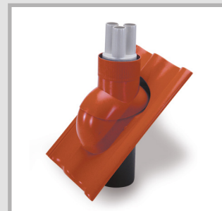
MSD110 mit drei Stutzen und drei Thermo-Schrumpfmuffen Geeignet für drei Kabel mit Durchmesser 7 – 28 mm; Als Zubehör sind verschiedene Aufteilkappen AK oder Verschluss-Stopfen VS30 lieferbar Produktname: MSD110/D3/30
