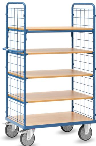
Baukasten-System: Aus Stahlrohr und Profilstahl geschweißt, pulverbeschichtet blau RAL 5007, Schraubkonstruktion. Stirnwände geschlossen mit Drahtgitter 100 x 100 x 5 mm. 1 fester und 4 lose Einlegeböden aus Holzwerkstoffplatten, Oberfläche Buchendekor. Einlegeböden variabel einsetzbar, Teilung 100 mm. Tragkraft pro Einlegeboden 90 kg. 2 Lenk- und 2 Bockrollen, TPE-Bereifung, Nabensicherung mit Rillenkugellager. Feststeller an den Lenkkörpern.
