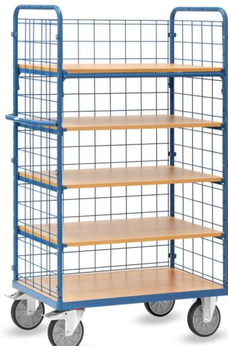
Baukasten-System: Aus Stahlrohr und Profilstahl geschweißt, pulverbeschichtet blau RAL 5007, Schraubkonstruktion. Stirnwände und 1 Längswand geschlossen mit Drahtgitter 100 x 100 x 5 mm. 1 fester und 4 lose Einlegeböden aus Holzwerkstoffplatten, Oberfläche Buchendekor. Einlegeböden variabel einsetzbar, Teilung 100 mm. Tragkraft pro Einlegeboden 90 kg. 2 Lenk- und 2 Bockrollen, TPE-Bereifung, Nabensicherung mit Rillenkugellager. Feststeller an den Lenkrollen.
