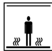
Flexible Heizungswindungen sind im Fußboden verlegt. NICHT mit Nägeln, Schrauben oder ähnlichen Gegenständen durchdringen. Die Wärmeabgabe des beheizten Fußbodens darf NICHT eingeschränkt werden. KEINE anderen als die empfohlenen Materialien anbringen
