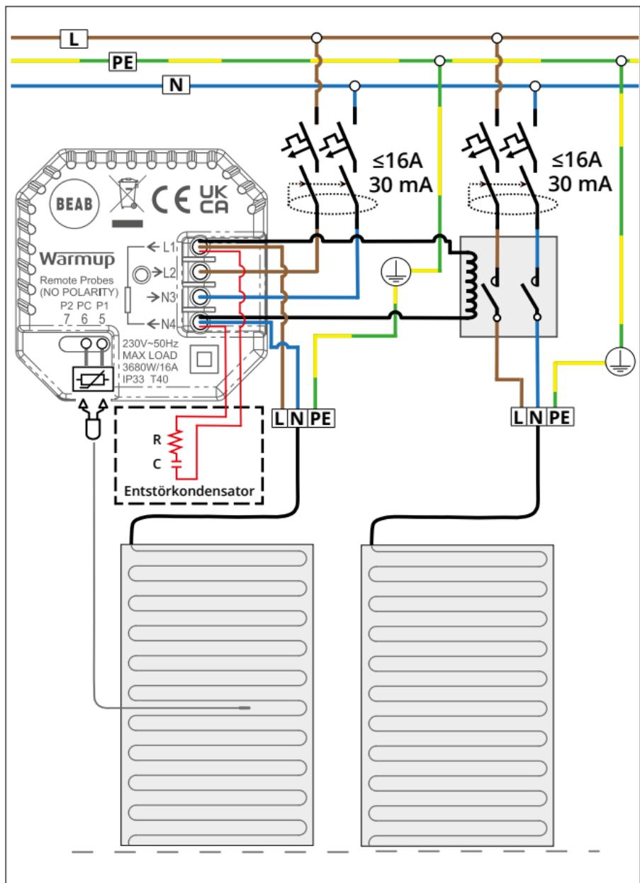
Warmup Thermostate sind für eine maximale Stromstärke von 16Ampere (3680 W bei 230 V) ausgelegt. Zum Schalten von Lasten, die 16 Ampere überschreiten, muss ein Schütz verwendet werden.
